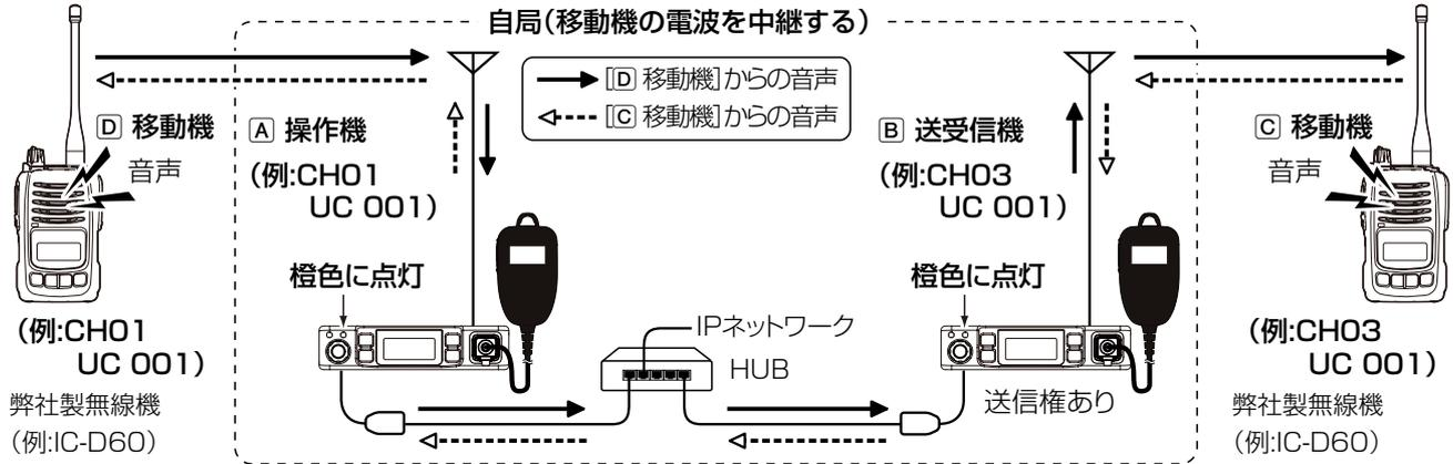
※コマンドマイクに「 回線エラー」が表示され、[データ]ランプが消灯(P.1-7)しているときは、[B 送受信機]の電源が入っていることを確認してください。
