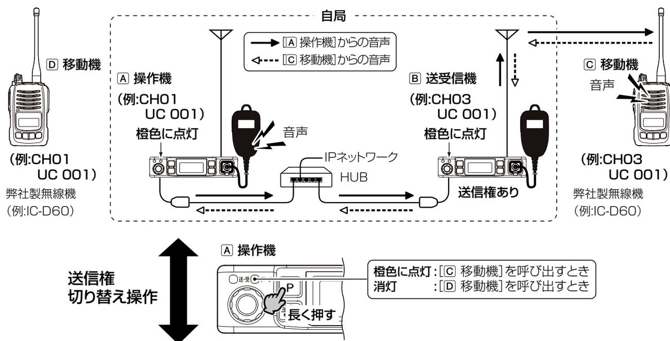
**[A]** 操作機から**[D]** 移動機を呼び出すとき
