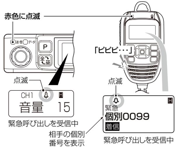
②操作機の【PTT】(送信)スイッチを押して、応答します。
