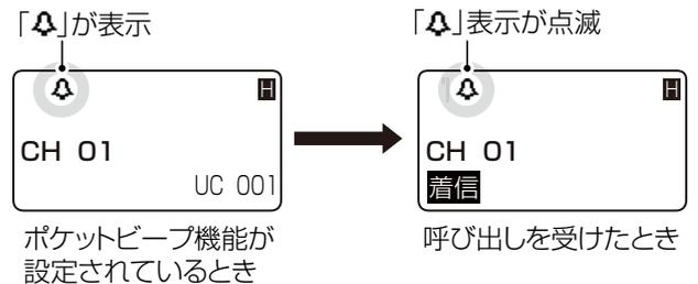
◎ ユーザーコードと個別呼び出し機能を併用している場合も、基地局呼び出し、または個別呼び出しを受けると「
