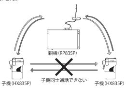
●子機が<u>8台以下</u>のときは、各子機にあらかじめ決められた周波数のチャンネルが割り当てられる<u>チャンネル固定通話方式</u>で通話を行います。子機を<u>9台以上</u>使用する場合は、システムの設定を自動通話方式に変更します。これにより、チャンネルを有効に使用することができます。自動通話方式では、同時に送信できる子機は<u>7台</u>になります。受信(=通話内容を聞くだけ)できる子機台数は無制限です。
