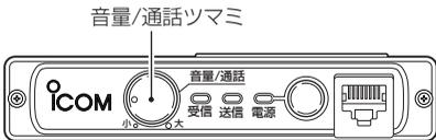
**【音量/通話】**ツマミを押すか、マイクロホンの**【通話】**スイッチを“OFF”にすると、ビーブ音が“プポツ”と鳴って、送信表示LED(赤色)と受信表示LED(緑色)が消灯し、両者とも(呼び出した方も呼び出された方も)回線が切れます。
