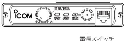
**[電源]**スイッチを約0.5秒以上押すと、ブープ音が“ブブッ”と鳴り、電源が切れます。一日の業務が終了すれば、必ず電源を切ってください。
