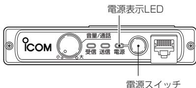
**[電源]**スイッチを約0.3秒以上押します。ブープ音が“ピピッ”または“ピッ”と鳴り、電源表示LEDが点灯します。
