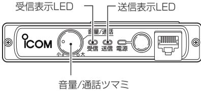
**【音量/通話】** ツマミを押すか、マイクロホンの**【通話】**スイッチを“ON”にするとビーブ音が“ピッ”と鳴り、送信表示LEDが点滅し、回線がつながるとビーブ音が“ピーポツ”と鳴り、送信表示LED(赤色)と受信表示LED(緑色)が点灯します。
