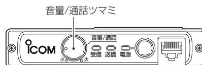
● IC-MS4055/IC-MS4066で通話を終了するときは、[音量/通話]ツマミを押すか、マイクロホンの[通話]スイッチを“OFF”にすると、ビーブ音が“プポツ”と鳴って、送信表示LED(赤色)と受信表示LED(緑色)が消灯し、両者とも(呼び出した方も呼び出された方も)回線が切れます。
