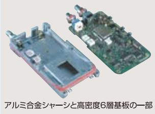
軽量で丈夫なポリカーボネートとダイキャストシャーシが高集積基板をガード。防水シールドのゴムは、衝撃吸収にも効果的です。ツマミ類も衝撃に強い高反発の樹脂素材です。
