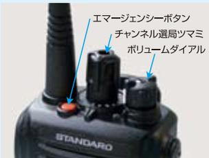
独立した選局ツマミとボリュームダイヤルは、アンテナが左に配置してあるので、右手でカンタンに操作ができます。VX-582では個別選択機能設定時、チャンネル選局ツマミを使い、メモリーした個別番号を呼び出すことも可能です。
