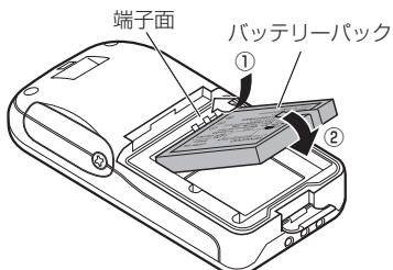
**!** 端子面の反対側を先に入れてからバッテリーパックを取り付けると本体の端子金具が変形することがあります。
