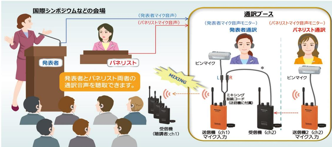
ミキシング送信機の近くに話者がいる場合、例えば通訳ブースから送信するようなケースでは、ミキシングパターン1の送信機1と受信機1を直接付属マイクの入力に置き換えることが可能です。
