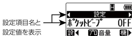
設定モード時、画面下部には、対応するキーに割り当てられている操作が表示されます。操作するときは、下図のように対応するキーを押します。
