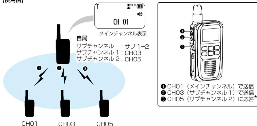
★「メインPTTチャンネルの切り替え」(P.4-23)を「応答」に設定した場合、応答できます。
