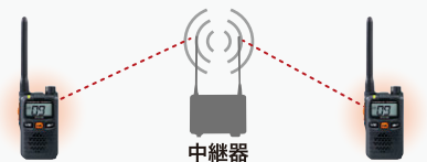
中継器接続で交互通話の約2倍にエリアを拡大
