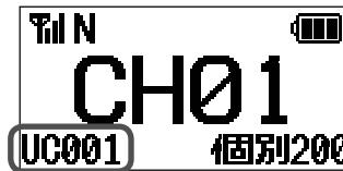
**補足** ディスプレイの右下に“個別”、“グループ”または“ALL”が表示されていない場 合はUC通信方式になっています。あらかじめセットモードの「S01 通信方式」 (36ページ参照) で“個別通信”に設定してください。
