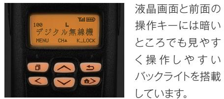
液晶画面と前面の操作キーには暗いところでも見やすく操作しやすいバックライトを搭載しています。
