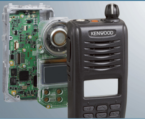
落下・衝撃に強い二重構造パネル
